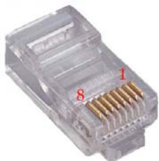
Рис.42. Контакты разъема RS-485 на стороне ИБП
